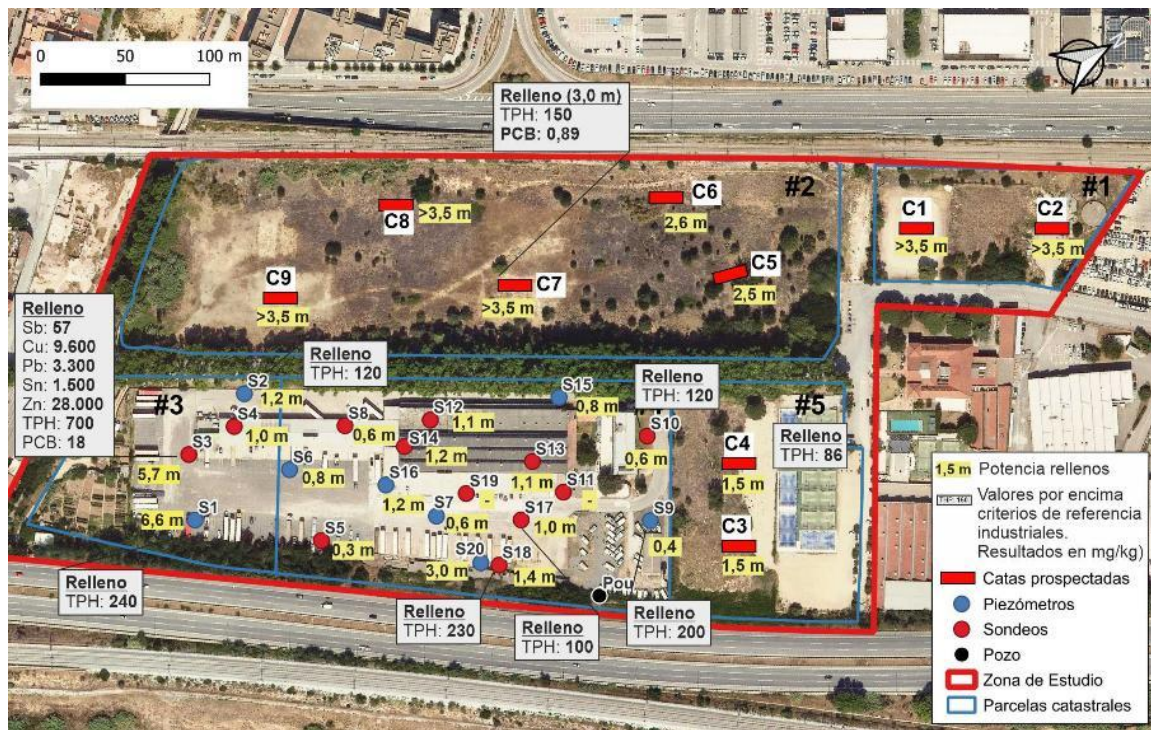
FIGURA 10. Concentraciones en suelo por encima de NGR y potencias de rellenos detectadas.
