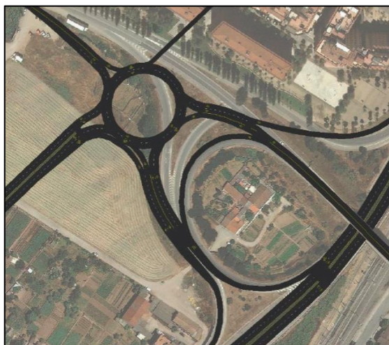
Figura 24. Detall de la nova rotonda d'enllaç entre l'avinguda Badalona i les carreteres C-17 i B-500
