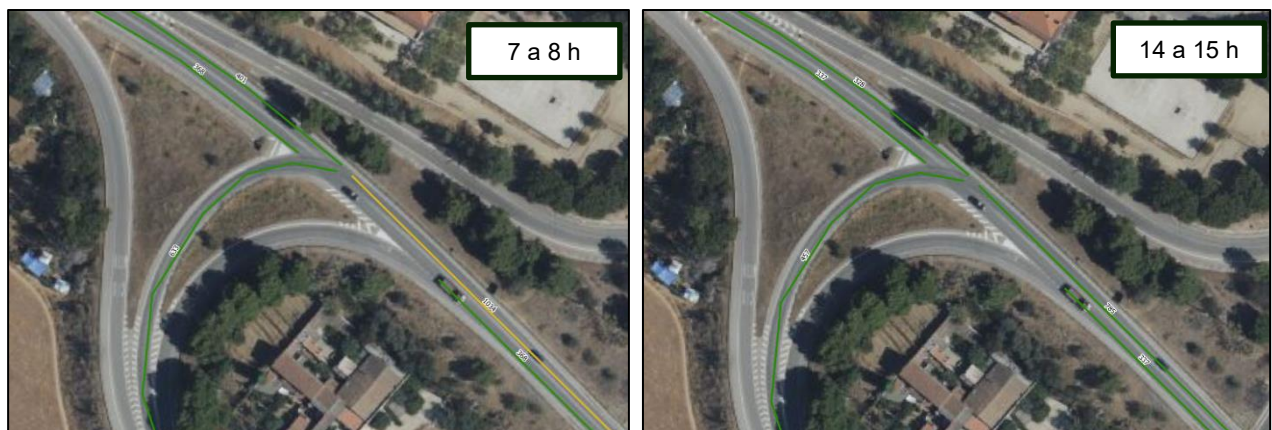
Figura 17. Nivells de servei 2025 confluència B-500 – accés C-17/C-33
